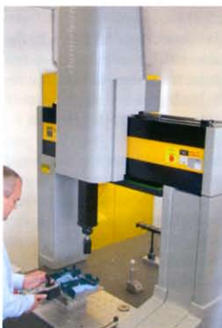
3D-Messmaschine der neuesten Generation.
